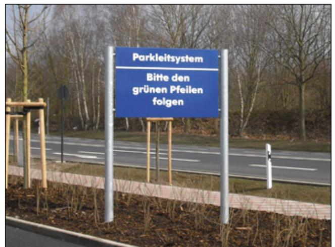
Hinweisschild 1.00 x 500 mm mit verzinkter Stahl-Unterkonstruktion
